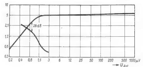
Bild 87. Empfindlichkeit und Signal/Rausch-Verhältnis beim Gerät Frankfurt
