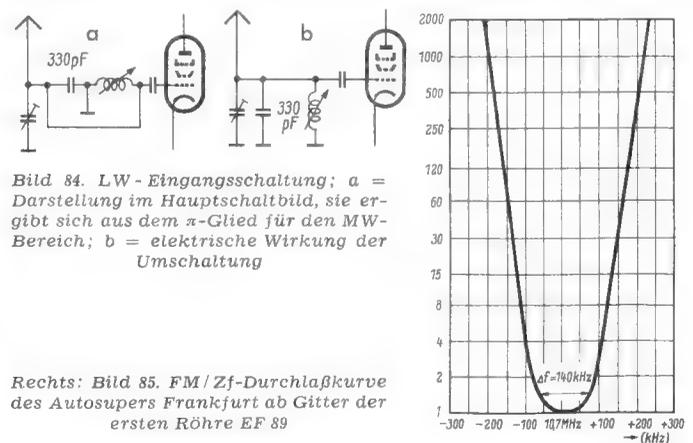
Bild 84. LW - Eingangsschaltung; a = Darstellung im Hauptschaltbild, sie ergibt sich aus dem  $\pi$ -Glieder für den MW-Bereich; b = elektrische Wirkung der Umschaltung
