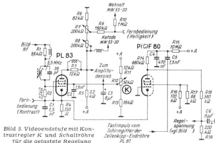
Bild 5. Videoendstufe mit Kontrastregler K und Schältröhre für die getastete Regelung
