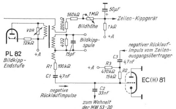
Bild 12. Bildkipp-Endstufe und die Zuführung der negativen Rücklaufimpulse zur Dunkelsteuerung der Bildröhre beim Zeilen- und Bildrücklauf, dazu Linearisierungsdiode EC (H) 81
