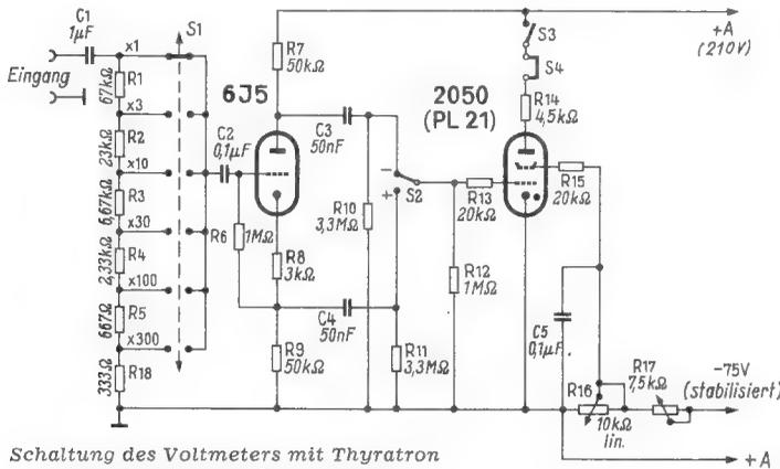
Schaltung des Voltmeters mit Thyatron zur Anzeige von Grenzwerten
