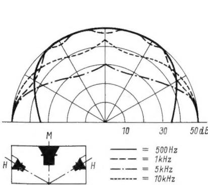
Bild 1. Richtcharakteristik eines Rundfunkgerätes mit einem Lautsprechersystem M für die tiefen und mittleren und zwei Systemen H für die hohen Frequenzen (nach Telefunken)
