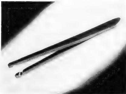
Als sehr praktisches Hilfsmittel hat sich eine isolierte Pinzette erwiesen, die ich mir aus zwei Abfallstreifen Vinidur selbst gefertigt habe. Die beiden Streifen werden zuerst zusammengeklebt und anschließend geformt (Bild). Jeder, der Interesse daran hat, kann sich eine solche Pinzette ohne Schwierigkeit selbst herstellen.
