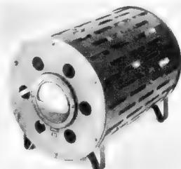
Bild 2. Ansicht der künstlichen Antenne für 100 W
