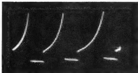
Bild 13. Oszillogramm der Multivibratorspannung am Gitter 1 des Triodensystems
