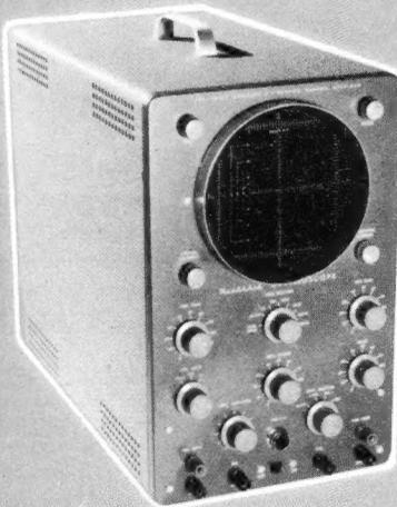
0-10 Breitband-Oszillograph, Bandbreite 5 Hz-5 MHz, Empfindlichkeit 10 mV/cm, Kippteil 10 Hz-500 kHz, Bildröhre 13 cm, Preis DM 599.-
