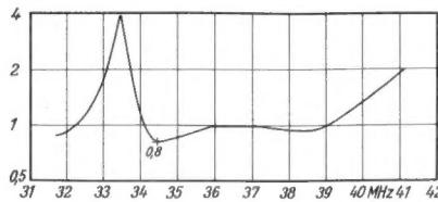
Bild 6. Durchlaßkurve des Bandfilters B1 mit Saugkreis ET für Eigentonträger
