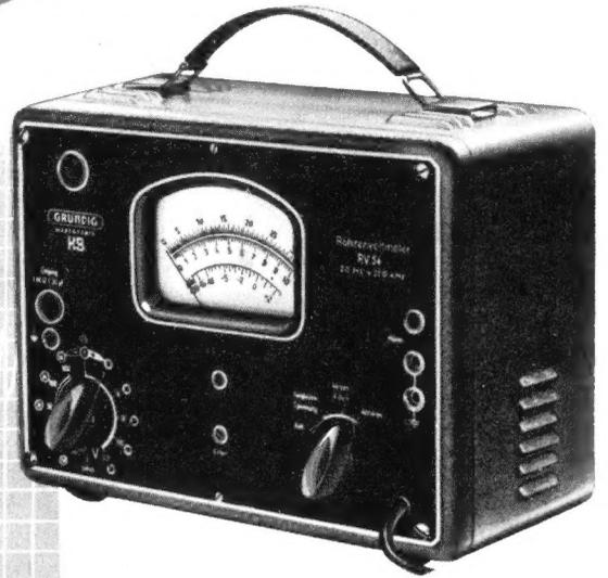
Das **GRUNDIG Röhrevoltmeter RV 54** besitzt einen Gesamt-Meßbereich von 3 mV bis 300 V im Frequenzbereich von 10 Hz bis 200 kHz. Sein hoher Eingangs-Widerstand, seine Unempfindlichkeit gegen Netzschwankungen und die starke, in den empfindlichen Meßbereichen bis zu tausendfache Überlastbarkeit machen das Gerät für die Praxis besonders wertvoll.
