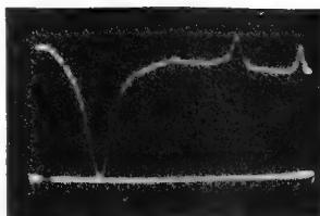
Bild 5. Mit dem Meßplatz aufgenommene Frequenzkurve eines Filters für 54 MHz über den Frequenzbereich von 50 bis 250 MHz
