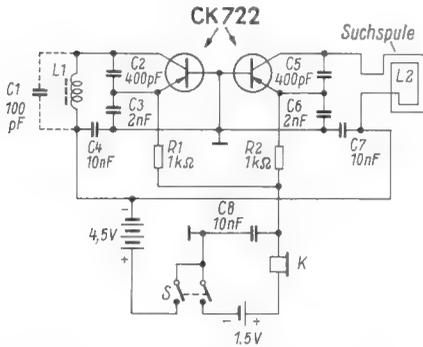
Bild 1. Einfaches Metallsuchgerät mit zwei Hf-Generatoren
