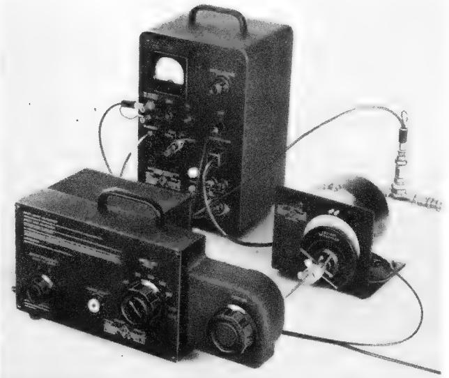
Bild 1. Aufbau eines Meßplatzes mit der Wobbeleinrichtung Typ 1750-A (vorn), dem Amplitudenstabilisator Typ 1263-A (hinten links) und einem Dezi-Meßsender (hinten rechts), dessen Abstimmknopf mit dem Wobbler gekuppelt ist
