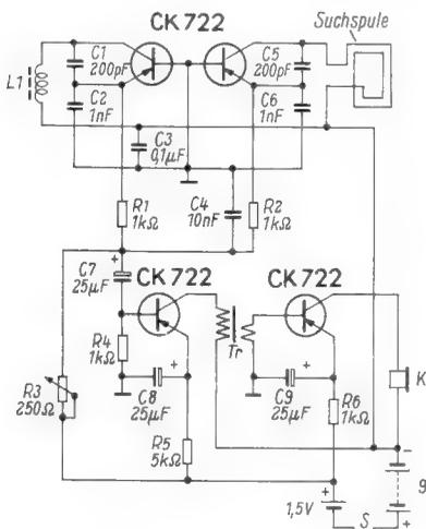
Bild 2. Empfindliches Metallsuchgerät mit zwei Hf-Generatoren und Nf-Verstärker
