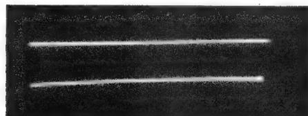
Bild 17. Gegeneinander verschobene Nulllinien bei unsymmetrischer Schirmgitterspannung
