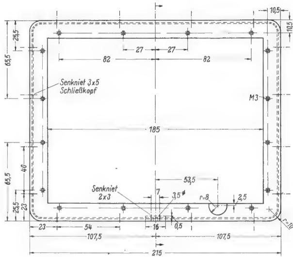
Bild 6. Gehäuse; Werkstoff: Tiefziehblech St. 37.21, Oberfläche: grauer Schruppflack
