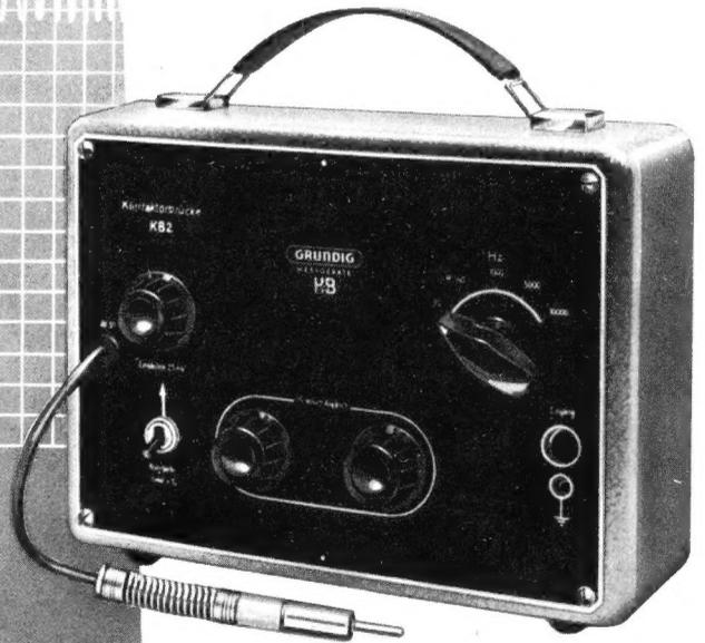
Die **GRUNDIG Klirrfaktorbrücke KB 2** stellt in Verbindung mit dem vorstehend aufgeführten GRUNDIG Röhrevoltmeter RV 54 eine in vielen Labors und Prüffeldern unentbehrlich gewordene Einrichtung dar. Der Klirrfaktormebereich geht von 0,2 bis 40%, wobei der Meßfehler nicht größer oder kleiner als 10% vom gemessenen Wert ist. Damit ist das Gerät praktisch für fast alle Aufgaben der Ela-Technik geeignet.
