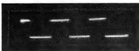
Bild 15. Spannungsverlauf an der Anode eines Hexodensystems
