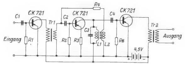
Bild 2. Dreistufiger, selektiver Nf-Verstärker mit Transistoren
