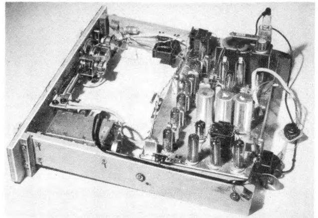
Bild 1. Blick in das Chassis. Links unten der Kanalschalter, links in der Mitte die Skala für die Kanalanzeige, daneben Regler und frontseitiger Hochtonlautsprecher
