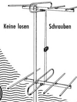
Die Antennen werden montagefertig im zusammengeklappten Zustand geliefert. Beim Aufstellen sind die Elemente umzuschwenken, bis sie selbsttätig durch Federkraft einschnappen und unverrückbar festsitzen.
