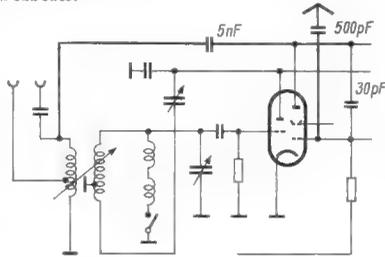
Die stark gezeichneten Verbindungen erweitern den DKE zu einem Reflex-Einkreiser mit aperiodischer Hf-Vorstufe
