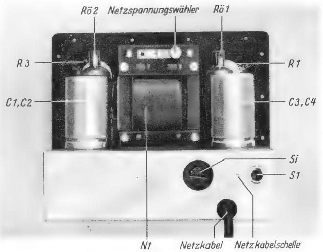
Bild 5. Rückseite des fertig montierten Chassis
