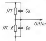
Bild 1. Kompensation der schädlichen Schaltkapazität
