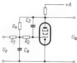
$$f_0 = \frac{1}{2\pi\sqrt{C_3 \cdot R_3 \cdot C_4 \cdot R_4}}$$
