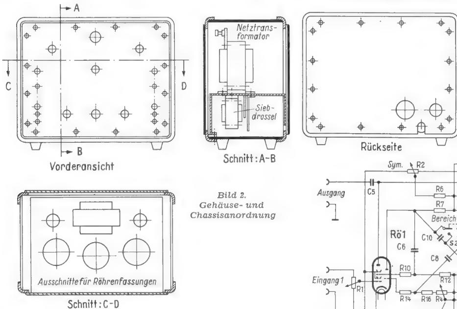
Bild 2. Gehäuse- und Chassisanordnung
