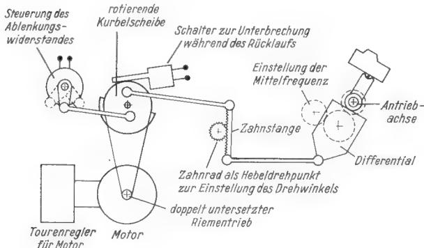
Bild 3. Skizze des mechanischen Antriebes des Wobblers 1750-A
