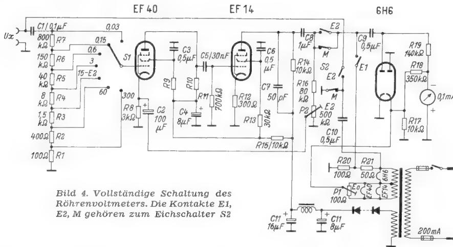
Bild 4. Vollständige Schaltung des Röhrenvoltmeters. Die Kontakte E1, E2, M gehören zum Eichschalter S2
