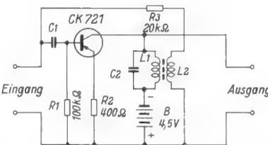
Bild 1. Einstufiger, selektiver Nf-Verstärker
