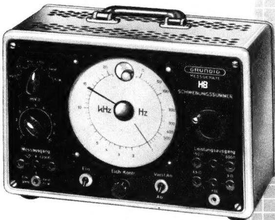
Der **GRUNDIG Schwebungssummer Typ 295** ist in seinem Frequenzbereich vom praktisch tiefsten Ton der Musik bis zu deren Obertönen von 20 kHz einstellbar. Damit sind Untersuchungen von Tonfrequenzverstärkern, Kabeln, Filtern und Lautsprechern möglich. Das Magische Auge dient zur Überwachung des Schwebungsnulls und kann auch als Aussteuerungsmesser bei Verwendung des Verstärkerteils als Meß- oder Musikverstärker dienen.
