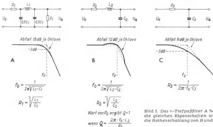
Bild 1. Das  $\pi$ -Tiefpaßfilter A hat die gleichen Eigenschaften wie die Reihenschaltung von B und C
