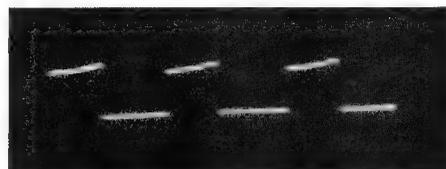
Bild 14. Spannungsverlauf an der Anode der Triode und am Gitter 3 der Hexode
