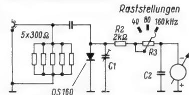
Bild 1. Schaltung der künstlichen Antenne für 100 Watt. Das Instrument ist direkt in Watt geeicht; für das 160-MHz-Band hat der Eichwiderstand R3 den kleinsten Wert. Der Trimmer C1 ist zweckmäßig auf Maximalausschlag des Instrumentes abzugleichen
